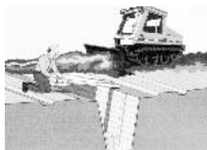
Оборудование перекрытой щели
